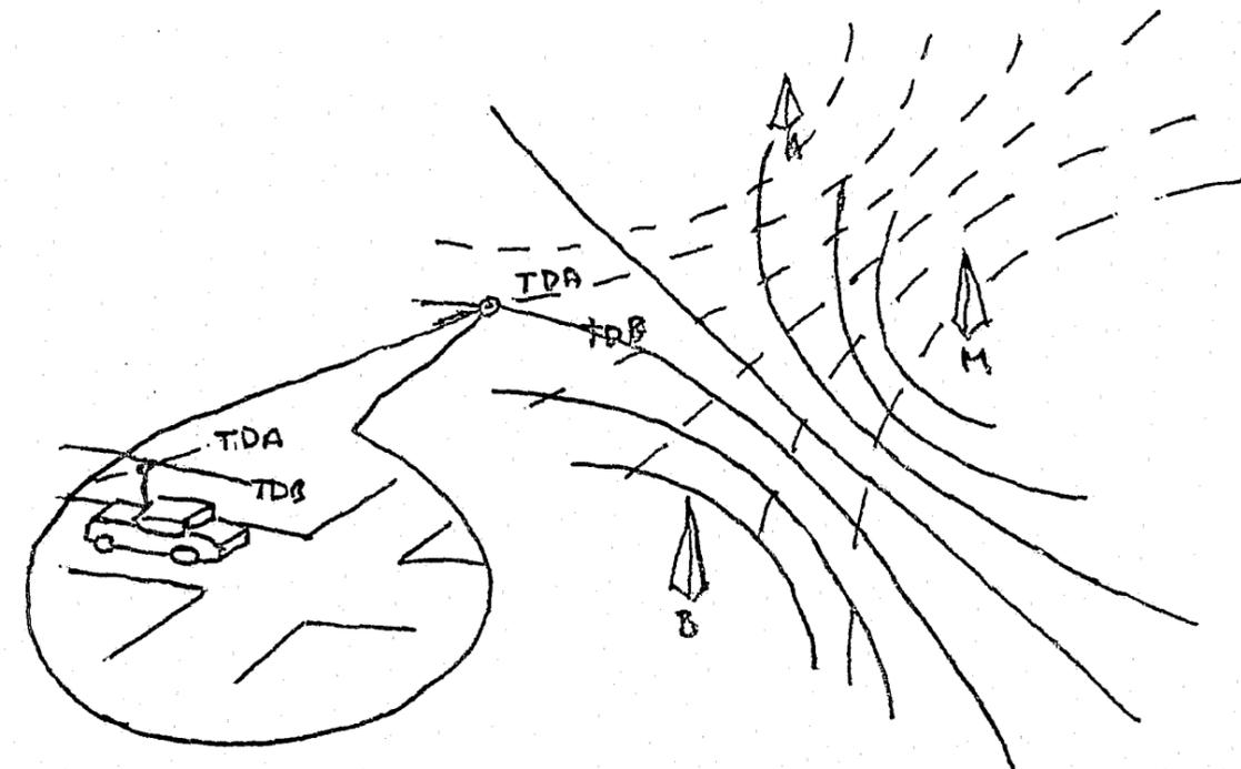
FIGURE 14 ILLUSTRATION OF TIME DIFFERENCE LOCATION FIX FOR LORAN
