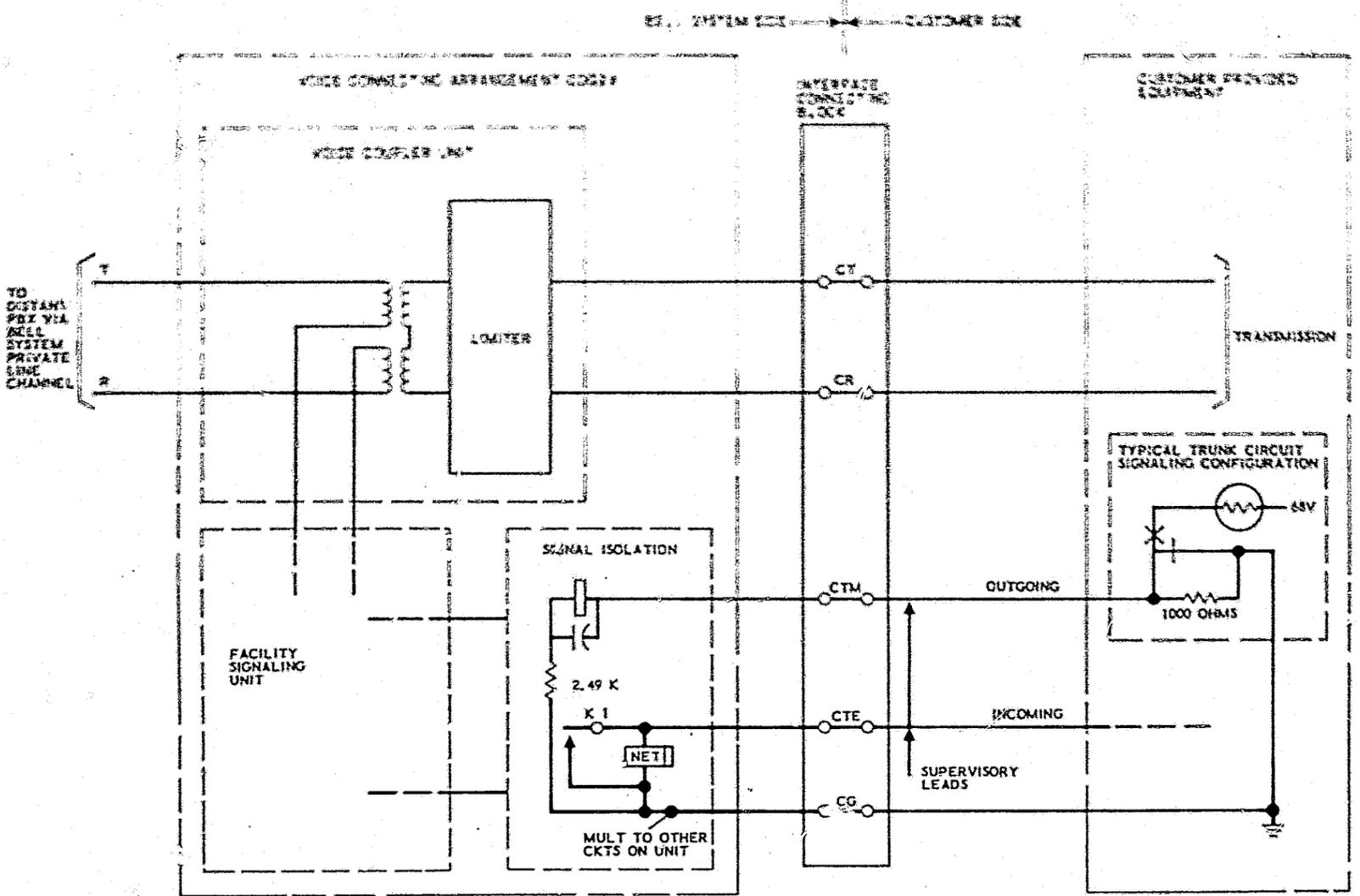
Figure 35. Voice Connecting Arrangement CDQ2X
