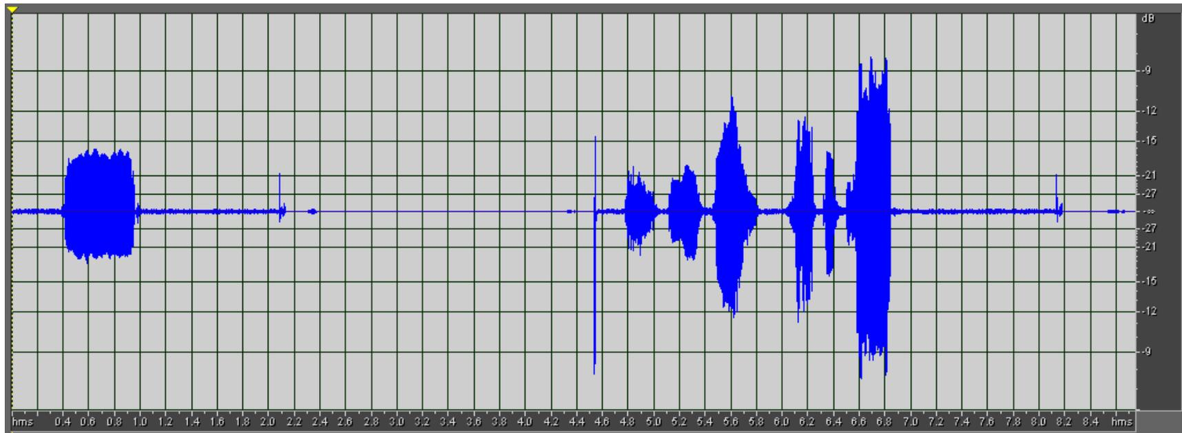
FIGURE 16 TYPICAL INTERFERENCE LIMITED AUDIO.GIF
